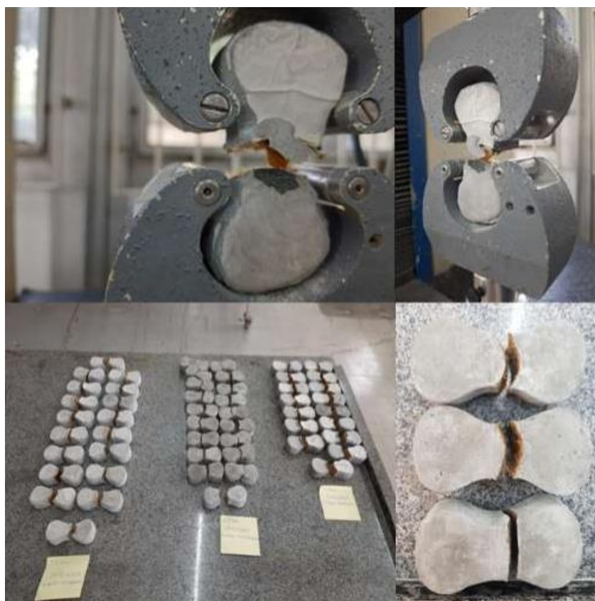
Fig.3 – Corpos de Prova pós Ensaio de Arrancamento.
