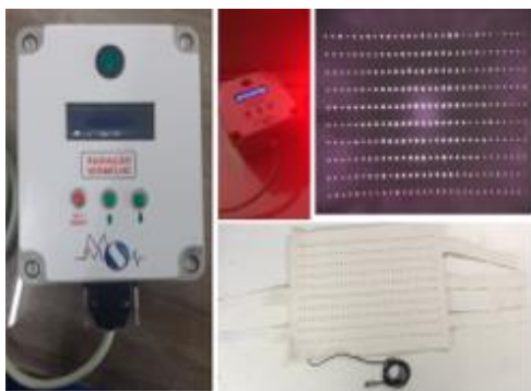
Figura 1: Sistema de irradiação infravermelho com colete de Led.
