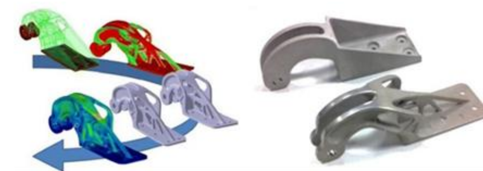
FIG. 1. TO e AM do suporte da dobradiça da nacela do Airbus A320. Esquerda: Processo de projeto do TO. Direita: Suporte original (superior) e projeto final otimizado do TO (inferior) [116,117]. Suporte original de aço = 918 g; suporte TO e AM em Ti6Al4V = 326 g. Direitos autorais: Airbus. (Byron, etal, 2021).
