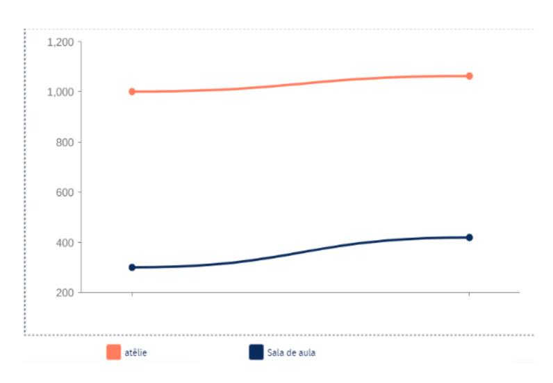
Valor indicado em norma no ateliê 1000 lux, valor adquirido em no local 1062 lux Valor indicado em norma na sala e aula 300 lux, valor adquirido no local 412
