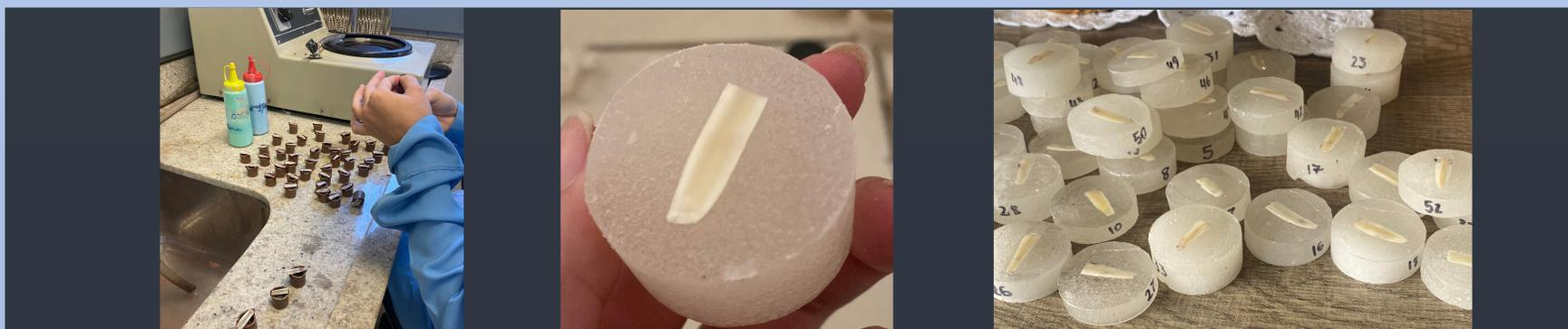
Fig. 1. Processo de polimento das amostras com discos de lixa e pastas à base de alumina em discos de pano;
