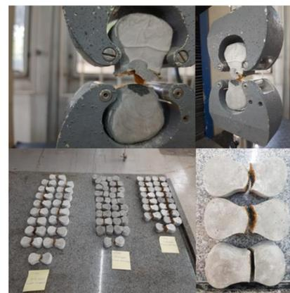
Todas as fibras das três configurações das amostras produzidas quebraram durante o ensaio de arrancamento. Portanto, na fase prática, reconheceu-se que as fibras curtas utilizadas neste estudo aderiram muito bem à matriz de cimento, mas tiveram uma tração muito baixa devido às cargas aplicadas durante os testes de arrancamento que causaram sua ruptura.
