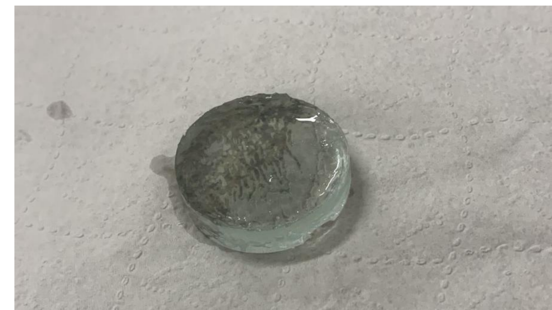
Figura 2- Aerogel após submersão em água por 72 horas.
